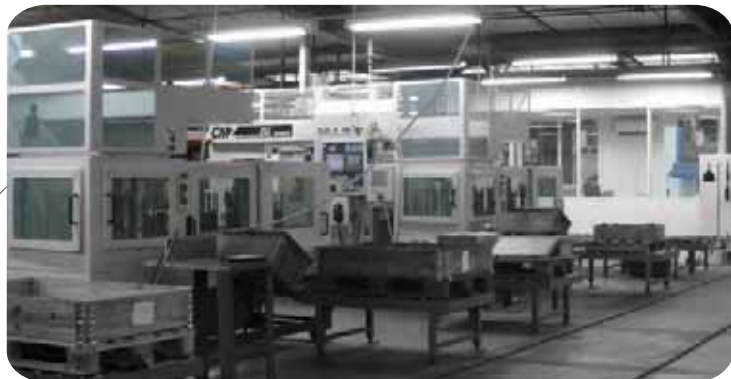
CELLULES ROBOTISÉES AUTOMATED TURNING UNITS Ø 40 - 200 mm / Length 10 - 205 mm
