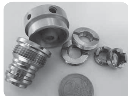
DÉCOLTAGE BI-BROCHE BAR TURNING MULTI SPINLES Ø 5 - 42 mm / Length 5 - 80 mm
